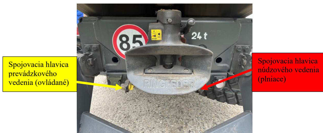
Obrázok 15 Pripojenie brzdového systému pre ťahané vozidlo-príves
