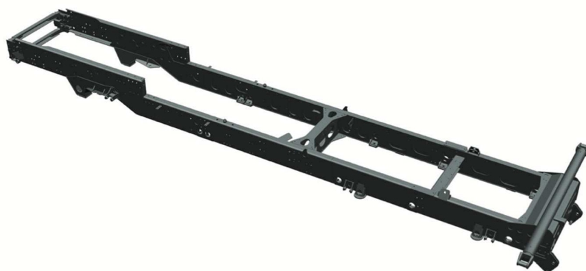
Obrázok 10 Pomocný rebrinový rám vozidla v prevedení 6x6
