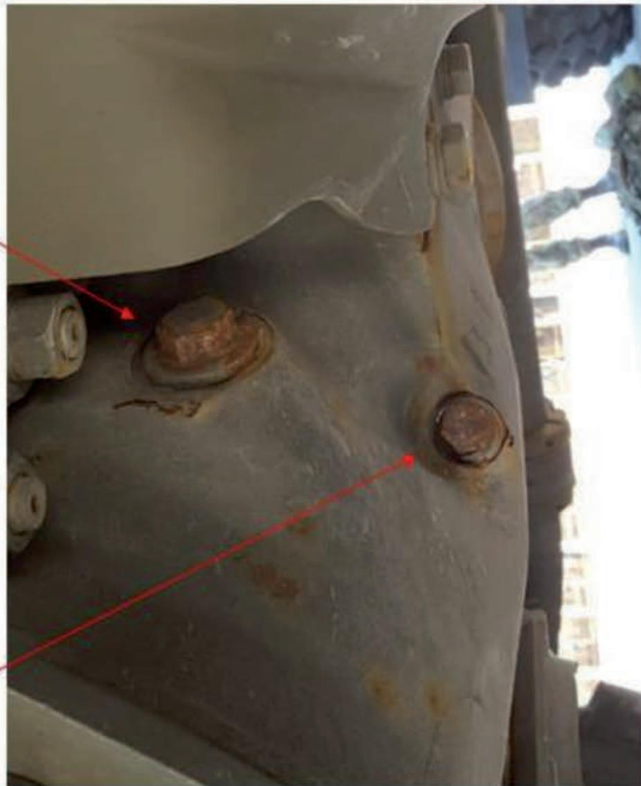
Obrázok č. 112 Olejová náplň v rozvodovke zadnej nápravy [30]
