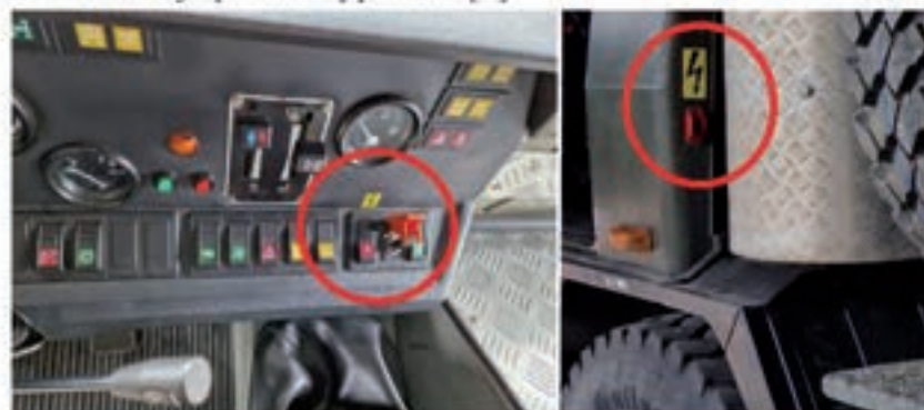
Obrázok č. 5 Hlavný vypínač batérie v kabíne vodiča a zvonku [21]
