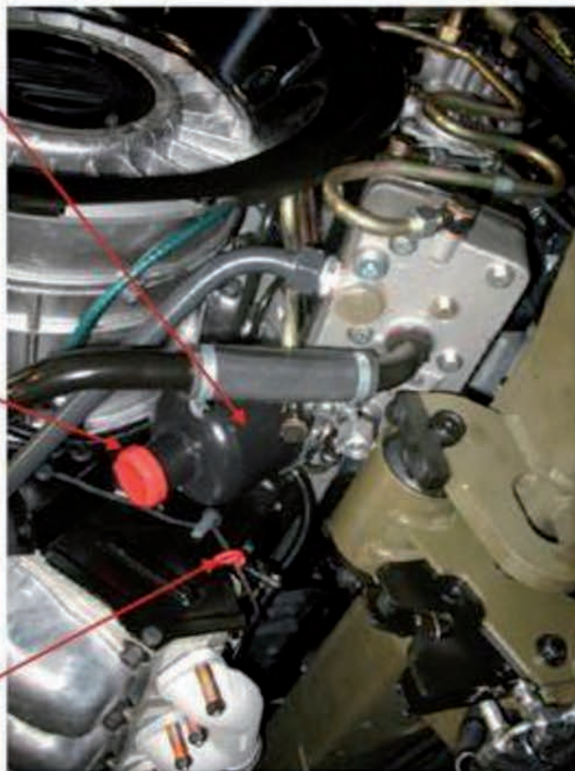
Obrázok č. 102 Olejová náplň motora [30]
