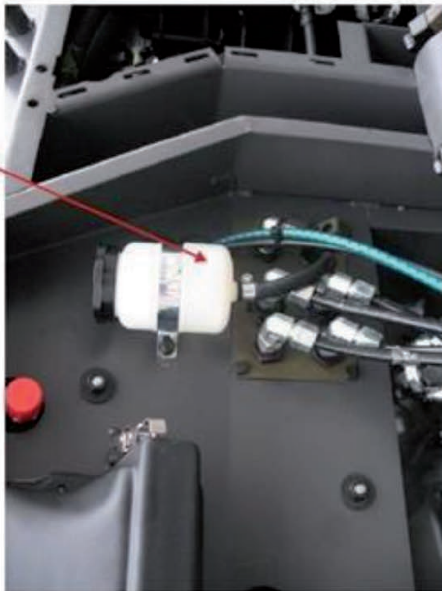
Obrázok č. 103 Náplň hydraulického okruhu ovládania spojky [30]
