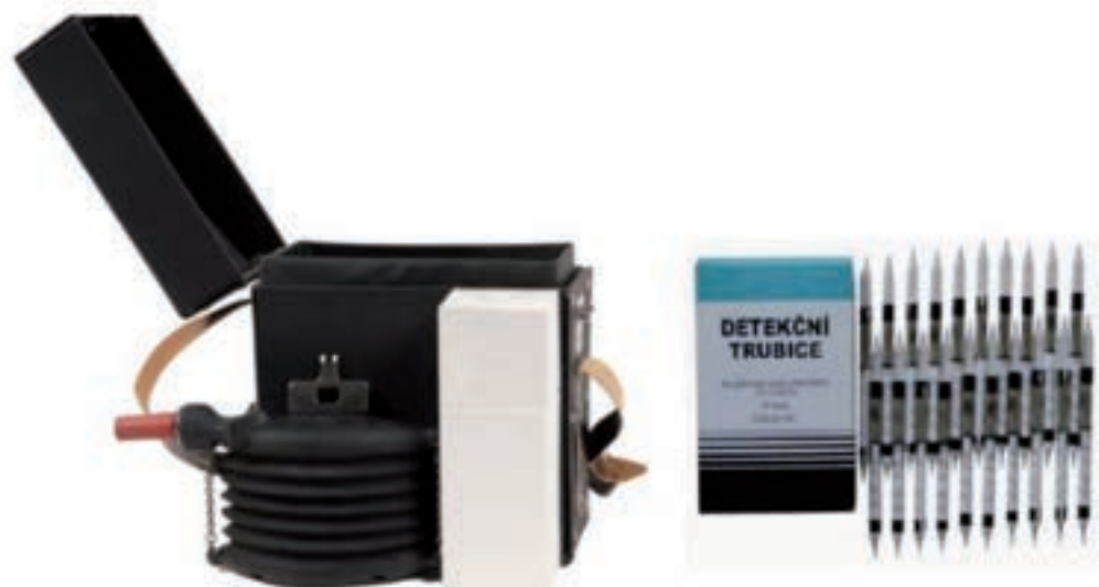
Obrázok č. 20 Detekčné trubice na stanovenie koncentrácie uhľovodíkových pár s nasávacím zariadením UNIVERZÁL vz.86 [15]
