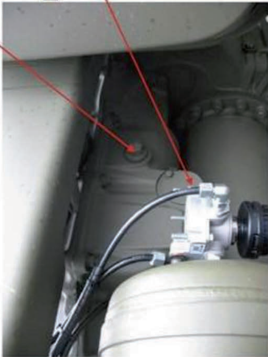
Obrázok č. 105 Olejová náplň prevodovky [30]
