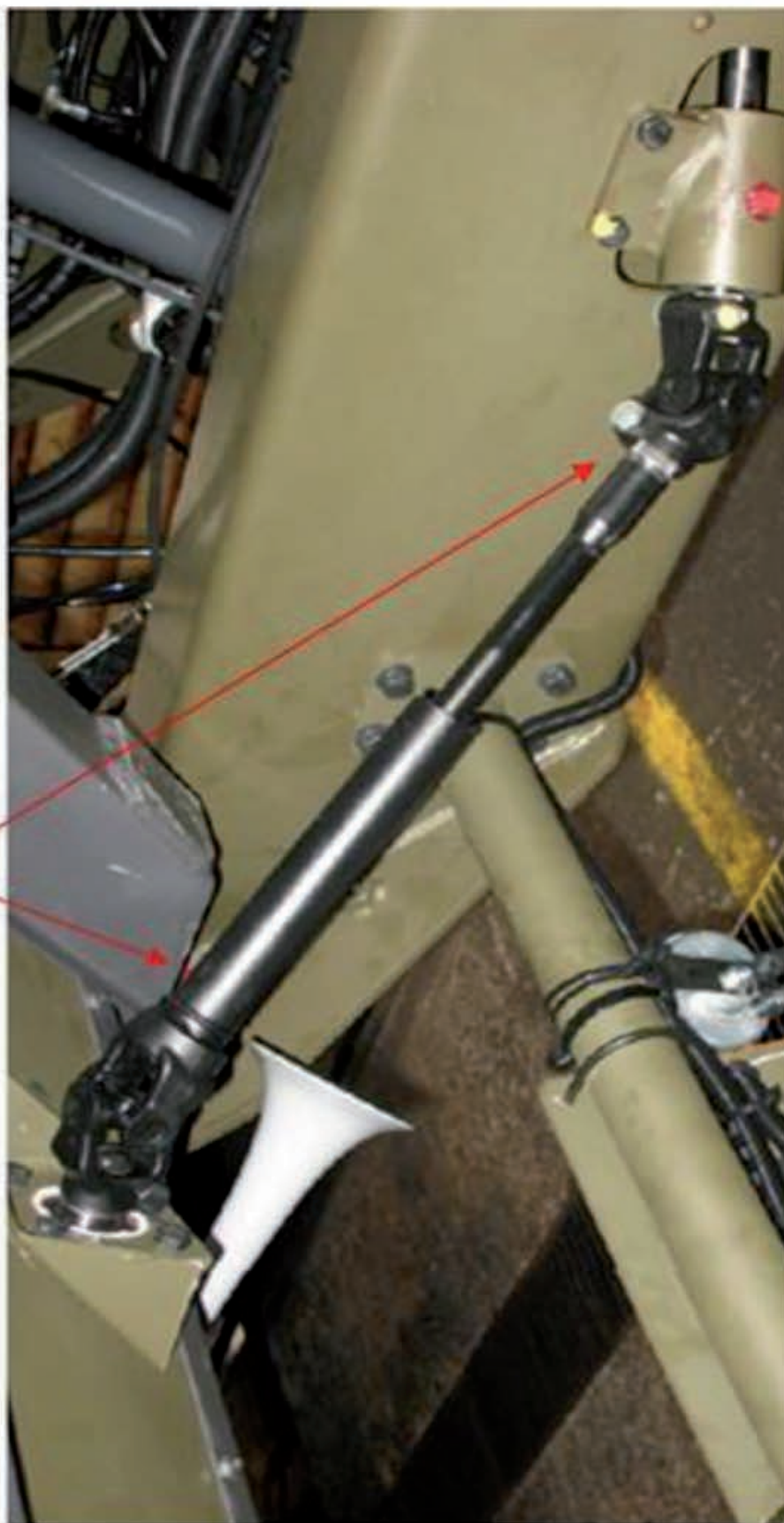
Obrázok č. 117 Teleskopické vreteno riadenia pod kabinou [30]
