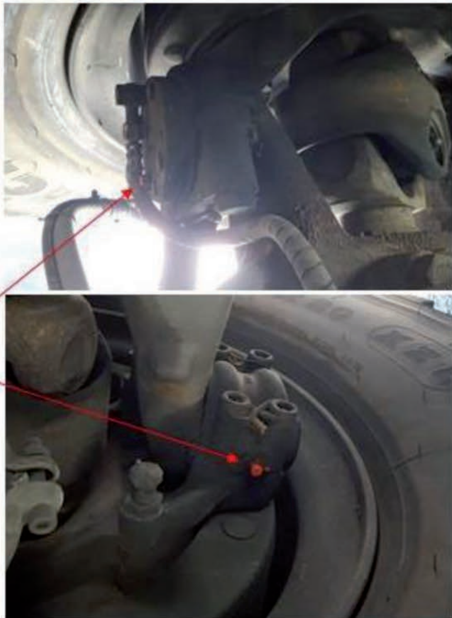
Obrázok č. 111 Horné a spodné uloženie otočných čapov [30]
