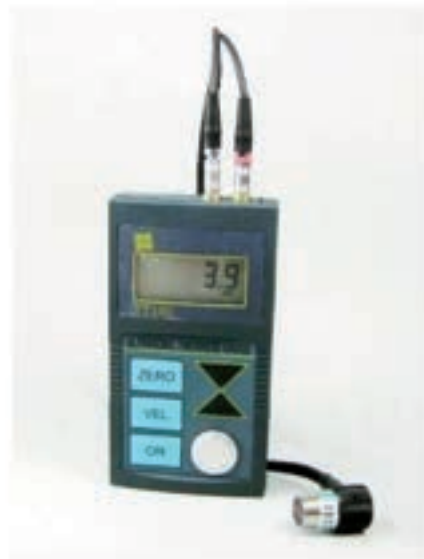
Obrázok č. 23 Ultrazvukový hrúbkomer DELTA TT100 [19]
