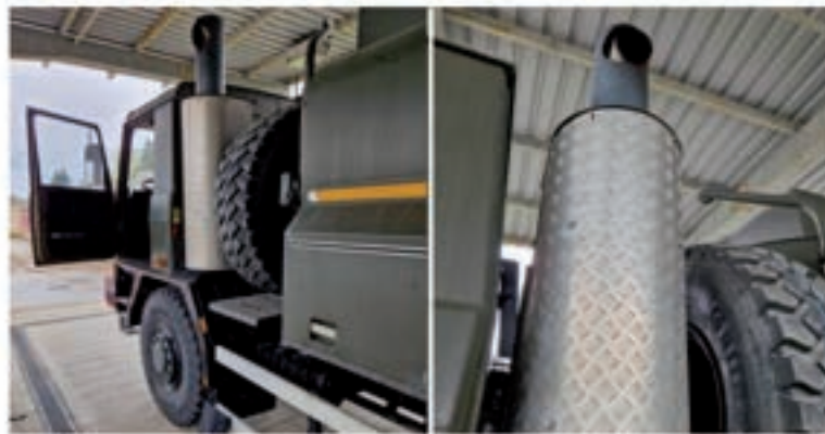
Obrázok č. 6 Inštalovaný tepelný štít na výfuku [21]
