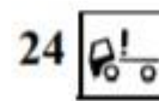
Obrázok 408. Kontrolné svetlo č.24 – nezaistenie kabíny [1]
