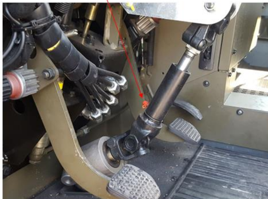
Obrázok 559. Teleskopické vreteno riadenia v kabíne
