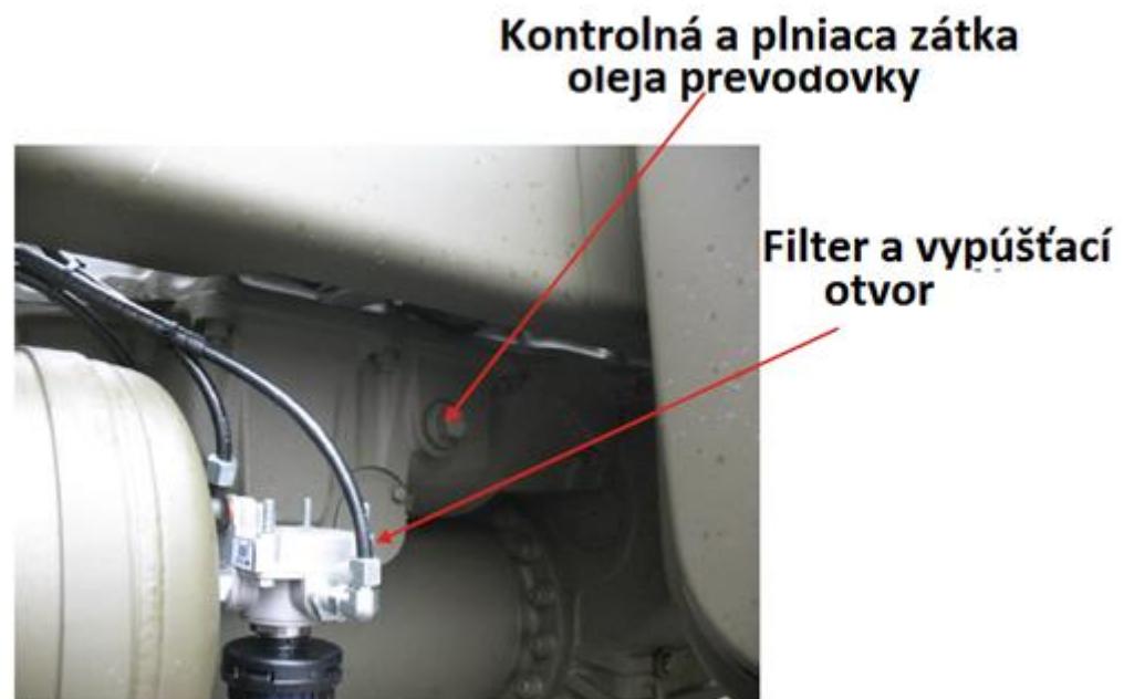
Obrázok 546. Olejová náplň prevodovky [4]
