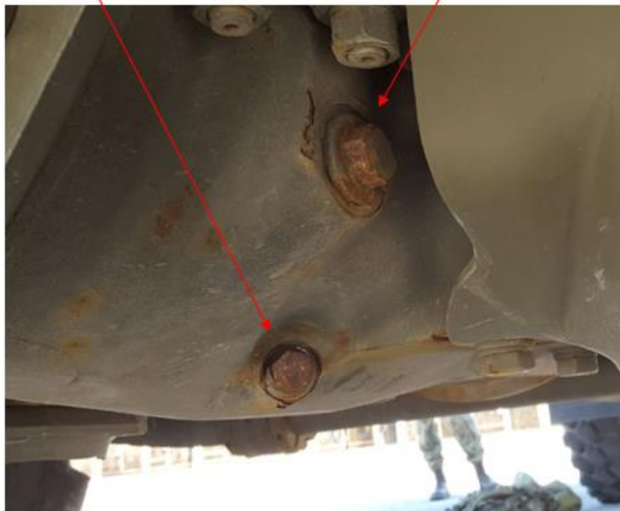
Obrázok 553. Olejová náplň v rozvodovke zadnej nápravy
