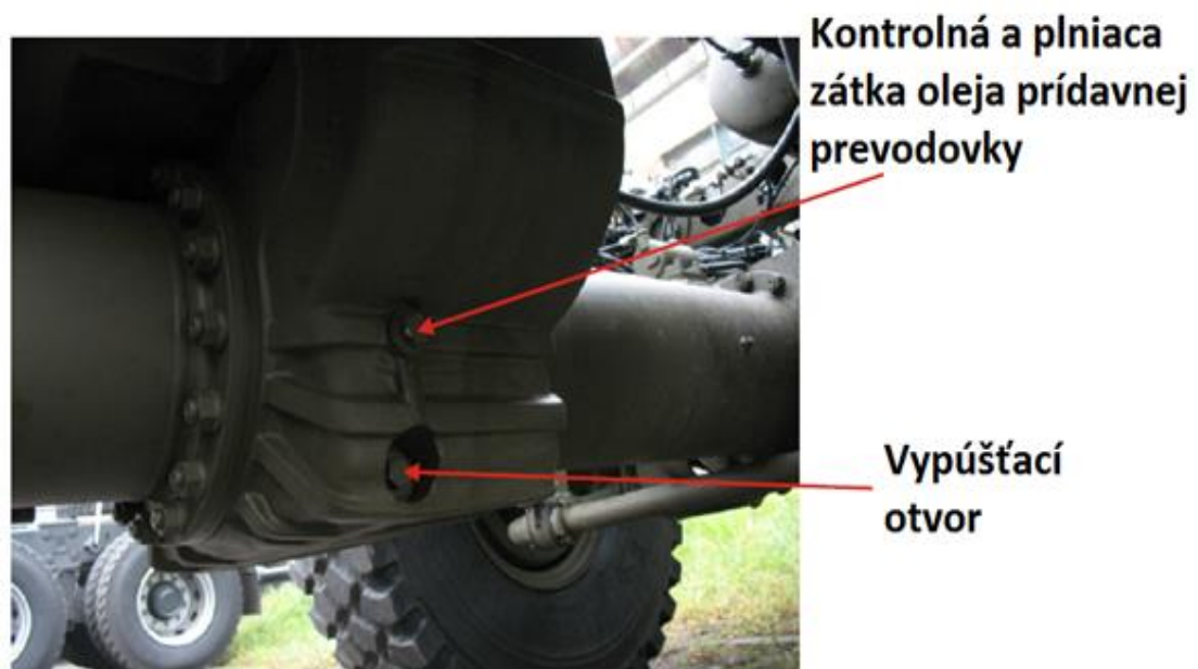
Obrázok 547. Olejová náplň prídavnej prevodovky [4]
