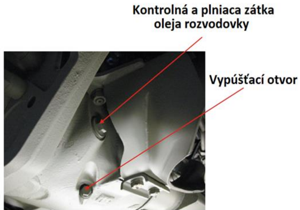
Obrázok 548. Olejová náplň v rozvodovke prednej nápravy [4]
