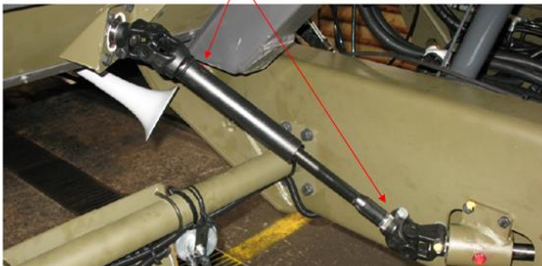
Obrázok 558. Teleskopické vreteno riadenia pod kabínou [4]
