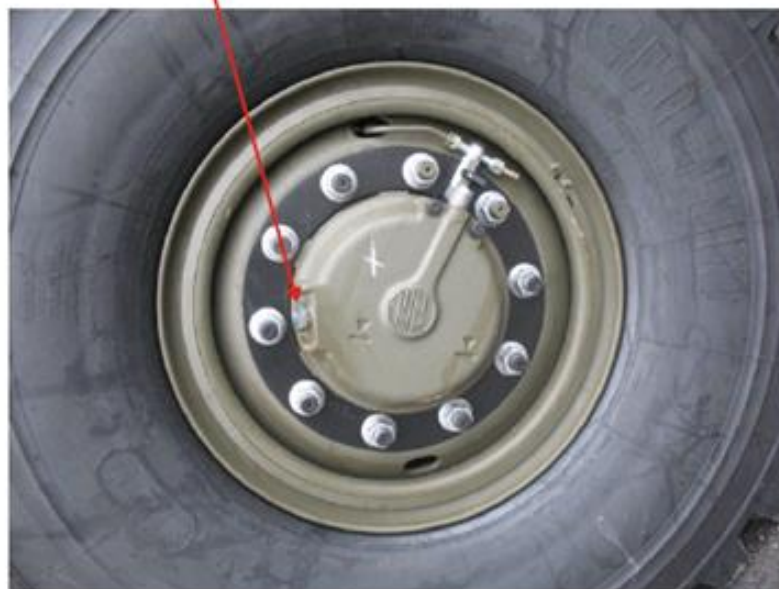
Obrázok 549. Olejová náplň kolesovej redukcie prednej nápravy [4]
