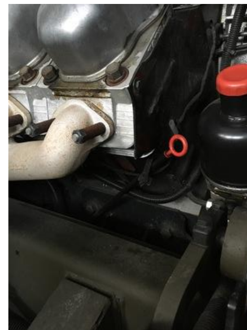
Obrázok 361. Umiestnenie kontrolnej mierky množstva oleja
