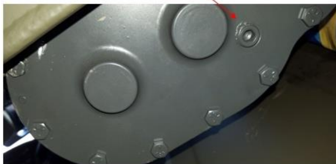
Obrázok 568. Kontrolný otvor šnekovej prevodovky
