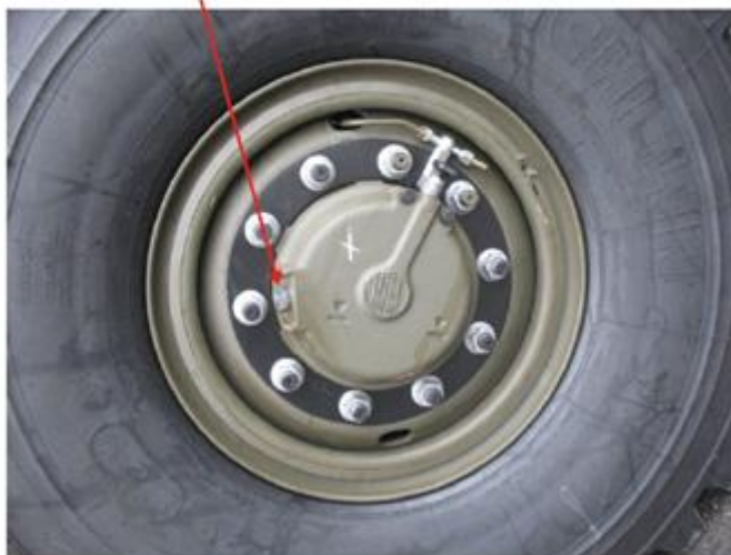
Obrázok 554. Olejová náplň kolesovej redukcie zadnej nápravy [4]
