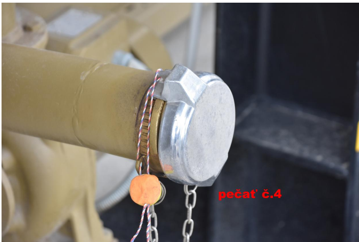
Obrázok č. 16. Detail umiestnenia pečate č. 4 na veku stáčacej/plniacej armatúry.
