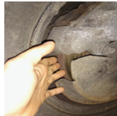
Obr. 35. Kontrola teploty brzdových kotúčov [16]
