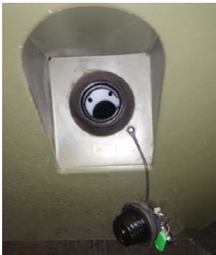
Obr. 34. Plniaci otvor palivovej nádrže [16]
