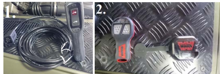
Obr. 51. Káblové (1) a bezdrôtové (2) diaľkové ovládania navijaka [16]
