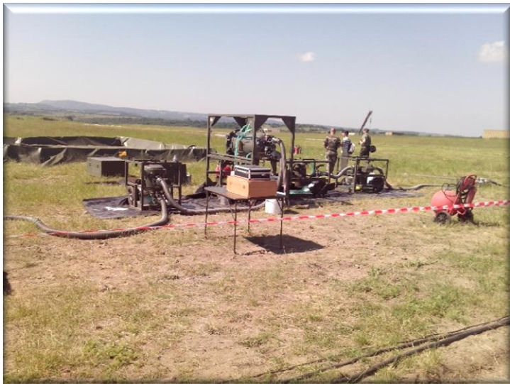
Obrázok č. 1. Rozvinutá poľná výdajňa PHM na doplňovanie vrtulníkov FBFI (Forward Bulk Fuel Instalation)
