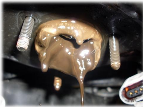
Obrázok 79. Oblasť pod zubovým čerpadlom mazacej sústavy ukazuje vyseparované zložky v podobe plastickej hmoty, ktorá zvyšuje hydrodynamický odpor v mazacej sústave motora- pripchávaním sít a drobných kanálikov sa podieľa na znížení mazacích tlakov
