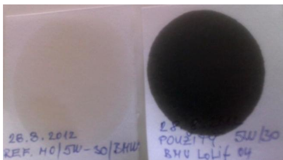
Obrázok 131. Po 2 hodinách, 2. skúška, vľavo: referenčná vzorka MO 5W-30, vpravo: vzorka použitého MO 5W-30
